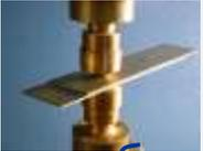
Сталь обладает более высоким электрическим удельным сопротивлением и более низкой теплопроводностью, чем медные электроды и этим самым значительно облегчает сварочный процесс.
